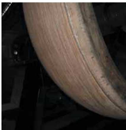
Восстановление вала дробилки с помощью Stoodly 100HD
