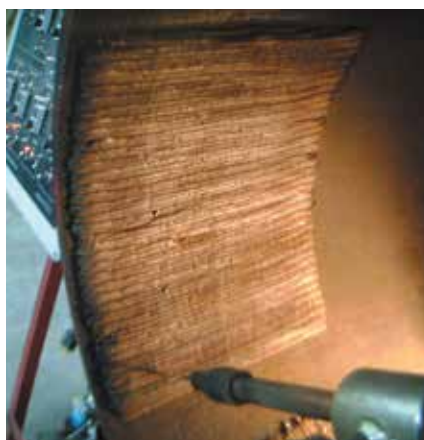
Горизонтальная облицовка внутреннего диаметра труб с помощью Stoodly CP-2000
