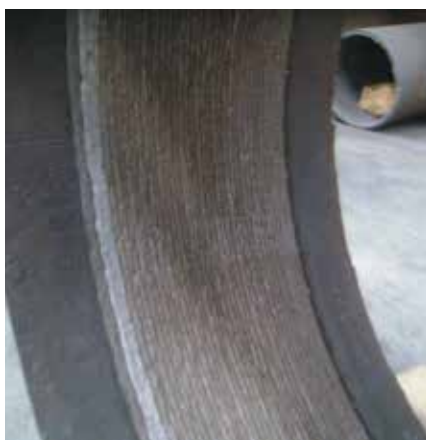
Облицовка внутреннего диаметра труб с помощью Stoodly CP-2000
