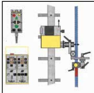
Система имеет гибкий направляющий рельс и устройство, обеспечивающее поперечное колебание электрода по заданным траекториям. Оснащена пультом дистанционного управления
