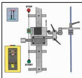
Система с комбинированным направляющим рельсом и возможностью сочетать положение точек начала и конца сварного шва с автоматическим возвратом на заднюю линию. Идеальна для многопроходной сварки.
