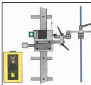
Механизированная система с гибким направляющим рельсом. Пригодна для сварки наружных и внутренних швов на плоской и криволинейной плоскостях.
