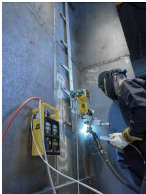
**Railtrac 1000** (Рейлтрак 1000) — это серия программируемого, портативного оборудования для механизированной сварки и резки. Применение этого оборудования избавляет сварщика от монотонной, изнурительной работы и в то же время позволяет увеличить производительность и обеспечить постоянство качественной работы. Railtrac предназначен для выполнения MIG/MAG сварки, TIG сварки и термической резки.
