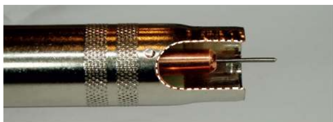
Неправильно. Наконечник глубоко утоплен в сопло
