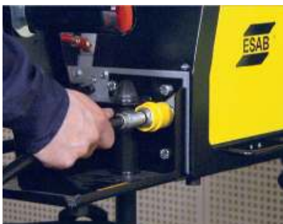
Шаг 6. Подключить проволокопровод к разъему подающего механизма. Избегать перегибов и точечных нагрузок на проволокопровод
