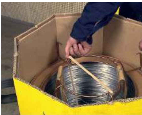
Шаг 1. Удалить резиновую ленту и бумажный индикатор конца проволоки.
