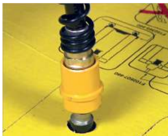
Шаг 5. Через быстроразъемное соединение подключить проволокопровод к крышке или конусу
