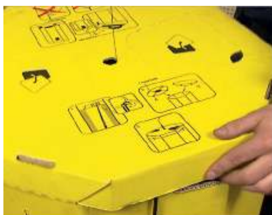
Шаг 4. Накрыть упаковку плоской картонной или пластиковой крышкой (для Стандартного и Мини Marathon Pac™) или конусным колпаком (для Большого Marathon Pac™)
