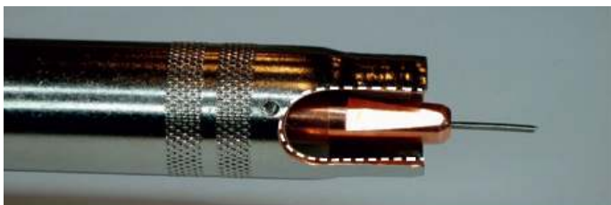
Неправильно. Наконечник выступает из газового сопла
